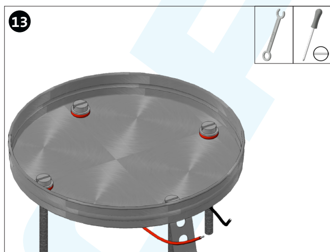
Nu zijn de vier schroeven en moeren zo strak aangedraaid dat de stukken slang samengedrukt worden om een afdichting te vormen. Controleer de resulterende schaal op lekkage met een beetje water.
