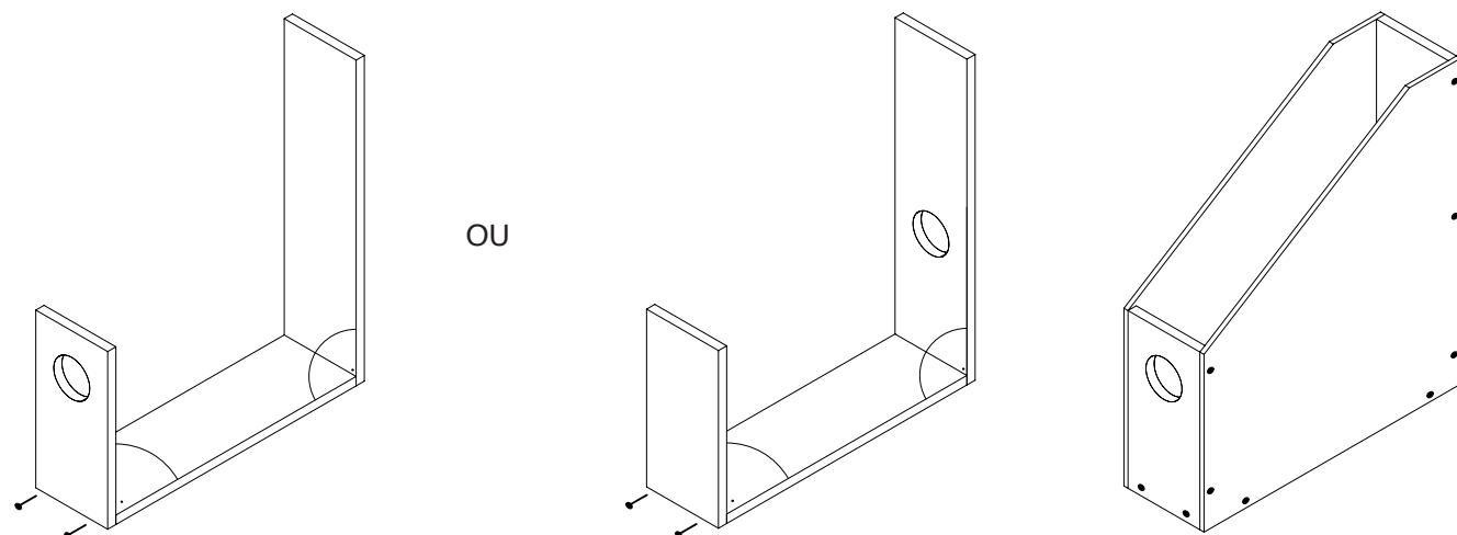
5. Enduire un côté du cadre avec de la colle, poser un élément latéral. Orienter correctement les éléments du cadre et fixer les éléments latéraux avec des clous. Fixer de la même manière l'autre côté du classeur.
