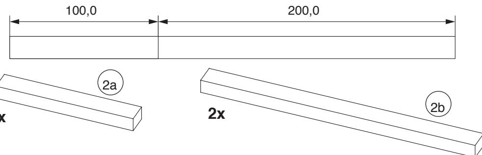
3. Selon le dessin, marquer deux lattes (1) 15 x 15 x 250 mm, percer un trou de 4 mm de ø et scier les trous longitudinaux.
