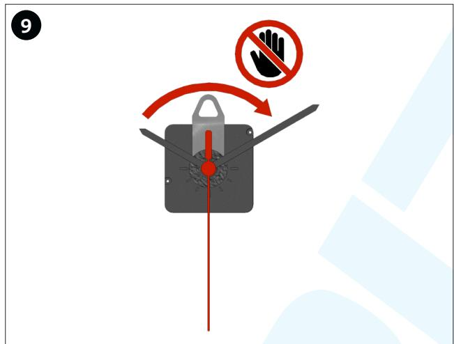
Il movimento inizia la sincronizzazione con il trasmettore DCF77. Le lancette fanno qualche giro, rimangono ferme per un po' e dopo un po' si regolano sull'ora corretta. Non spostare o fermare il puntatore con la mano durante questo periodo!
