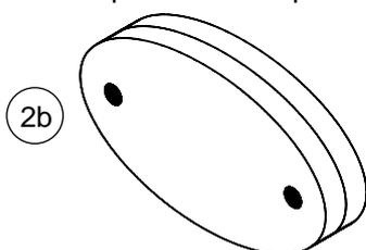
6.1.7 Réunir la partie inférieure du bec (3a), une vis (7), le support du bec (2b) et la tête (v. dessin). Ajuster, selon dessin, la partie inférieure du bec (3a) et le support (2b). Marquer la position des supports sur la partie inférieure du bec et démonter cet ensemble. Coller, en vous référant au marquage, le support sur la partie inférieure du bec. Fixer avec le serre-joints.
