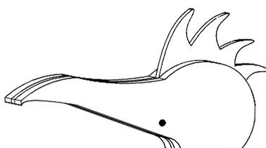
6.1.5 Dans la lattes (3) on scie une pièce (3a) de 120 mm que l'on façonne pour obtenir la partie inférieure du bec (v. dessin).
