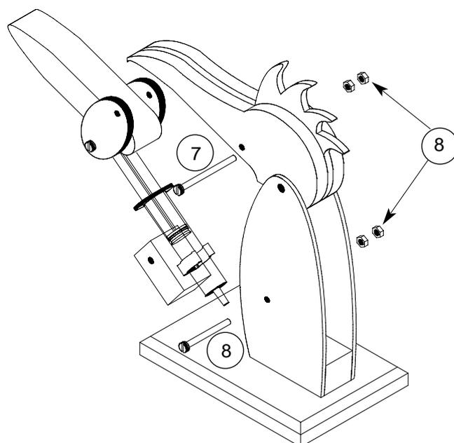
6.4.6 Aligner la partie inférieure du bec et l'injecteur de manière que le bec soit fermé et le piston de la seringue à moitié sorti.
