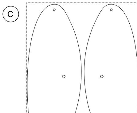
6.2.2 Superposer les pièces découpées et fixer. Marquer les perforations selon gabarit C et percer avec une mèche de 4 mm. Poncer les deux pièces en une seule opération.
