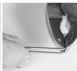
Doblar a 90° con alicates o con un tornillo de banco
