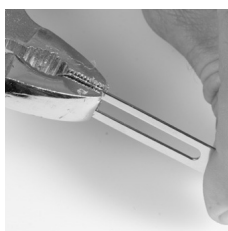
Doblar a 90° con alicates o con un tornillo de banco
