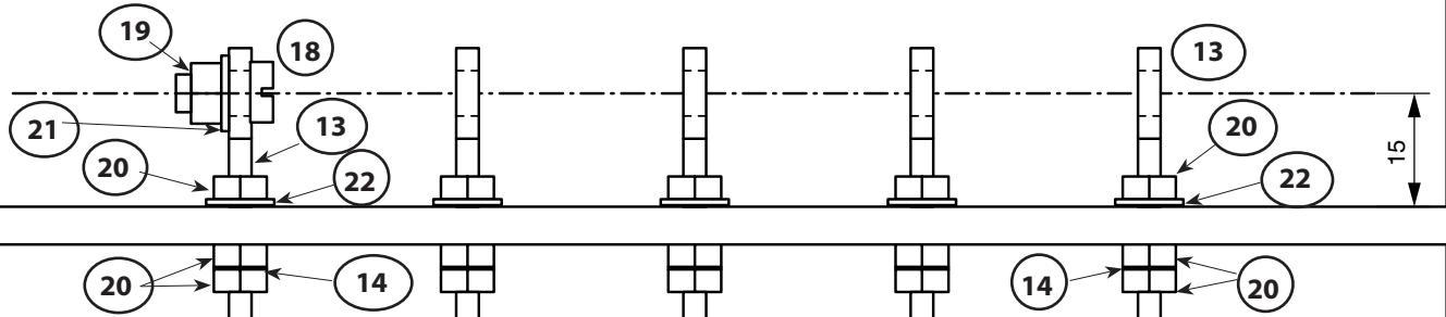
6.2.2 Von unten auf jede Gewindeöse M4 (13) eine Mutter M4 (20), eine Lötöse (14) und wieder eine Mutter M4 (20) aufschrauben
