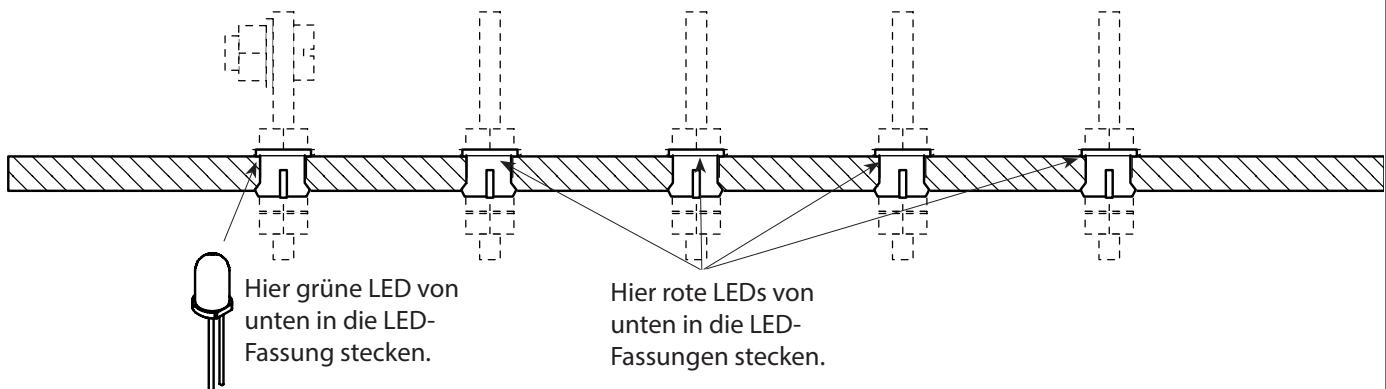
6.2.8 Grüne LED (11) von unten so in die LED-Fassung stecken, dass die Kathode (abgeflachte Seite) in Richtung Ringöse (13) zeigt.
