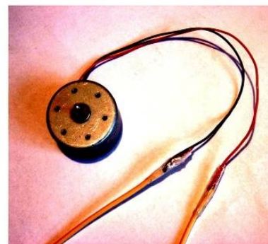
La conexión entre el cable del motor y el cable cocodrilo se cubre con cinta adhesiva.
