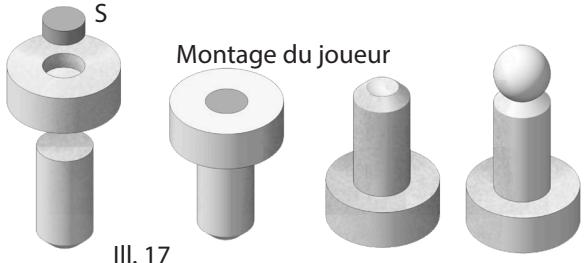
17. Marquer le milieu sur le bout de baguette biseauté au point 15 à la fois en haut et en bas. Visser la pièce prépercée (9) obtenue au Point 14 avec une vis (24), au milieu du corps qui a été chanfreiné. Coller un aimant (12) dans le trou de 15mm. Retourner le joueur qui est ainsi presque terminé et biseauter un creux pour la tête sur le point médian indiqué sur le corps. Coller la tête (boule en bois, 8). Répéter les étapes 13-17 pour le deuxième joueur.
