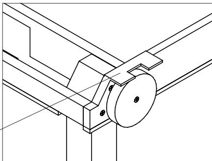
10. Découper la plaque en caoutchouc mousse (7) selon le pochoir (page 9). Comme sur l'illustration 10, coller les 2 butoirs en caoutchouc mousse 100x20mm dans le puits destiné à la balle, exactement derrière le but. Remarque: les plaques en caoutchouc mousse devraient être mises en peinture avant d'être collées.
