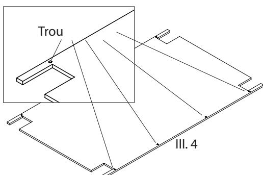
4. Prépercer les trous de Ø3mm pour la fixation des parois latérales sur la plaque de fond. Chanfreiner chaque trou à l'aide d'un outil à chanfrein par le bas (Voir ill. 4 et pochoir Page 5).
