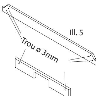
5. Prépercer les trous de Ø3mm pour le vissage ultérieur, tel qu'indiqué à l'illustration 5 pour les côtés et les lattes du but et chanfreiner de l'extérieur avec un outil à chanfrein. (voir pochoir page 7)
