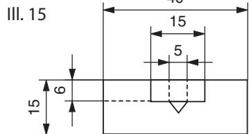
15. Sur le point médian de la roue en bois percer un trou borgne de 6 mm de profondeur et d'un diamètre de ø15. Au milieu de cet évidement, chanfreiner le trou obtenu, pour le logement de la vis. (voir dessin III. 15)
