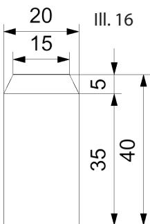
16. Biseauter la pièce ronde sciée au point 13 (Longueur 40mm) sur un côté sur env. 30° avec une lime à bois ou du papier émeri (voir III. 16)
