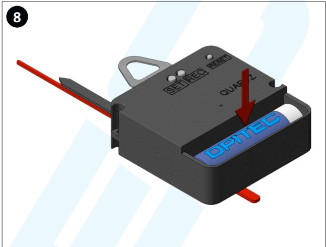
Insertar la pila con la polaridad correcta y colgar el reloj en la pared. La mejor recepción se consigue cuando la esfera se orienta en dirección al origen de la señal (Frankfurt am Main, Alemania).
