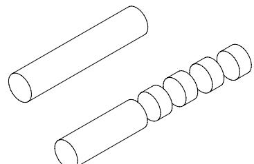
10. Serrer les rondelles dans un étau de machine et à travers chaque rondelle percer un trou de 2 mm de Ø.
