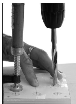
4. Séparer à nouveau le paquet de 3 plaques acryliques (on peut également ôter la feuille de protection). Avec un foret alésoeur à 90°, chanfreiner tous les trous de 10 mm d'un côté sur env. 3 mm de profondeur (utiliser un support de perçage!).
