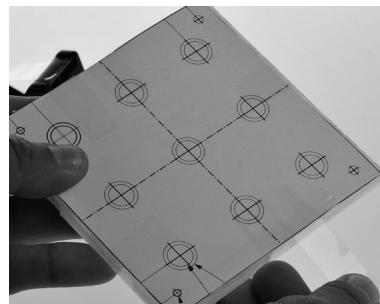
2. Fixer ce "paquet" de plaques acryliques avec des serre-joints sur un support de perçage (plaqué contreplaqué entre autres).
