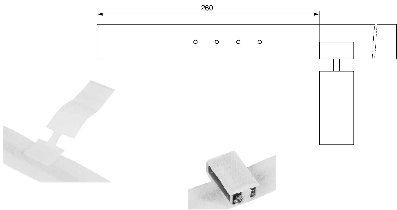
7. LEDs der Reihe nach in die Löcher vom Flauschband stecken und Kabel bis zur Batterie verlegen.
