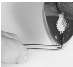
piegare mediante pinza oppure morsa ferma pezzo 90°
