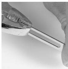
piegare mediante pinza oppure morsa ferma pezzo 90°
