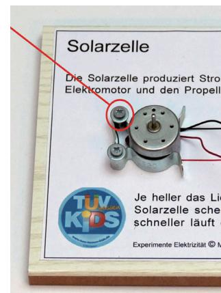
Montar el motor en la abrazadera. El motor viene con un cable rojo y otro negro incorporados.
