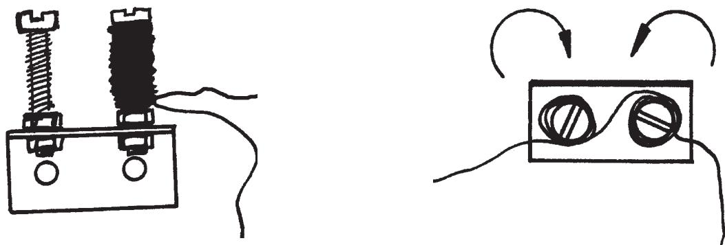
El conjunto se fija en la base como se indica en la figura. Con ello el montaje mecánico ha terminado.
