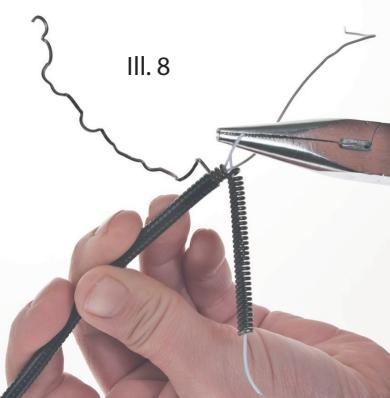
9. A la lampe (3), dérouler la couche de métal extérieure sur env. 50 mm. Déplier le ressort courbé avec la pince de pliage et tirer les deux câbles à travers la place libre ouverte qui résulte du pliage. (voir ill. 8)
