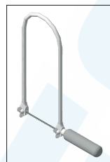
Scie à chantourner
